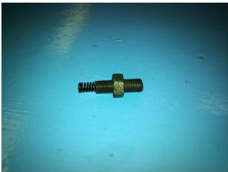
Рисунок 3 — Винт упора поддержания холостого хода
